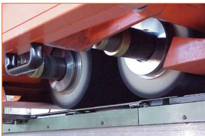
Pulitura profilati di alluminio
